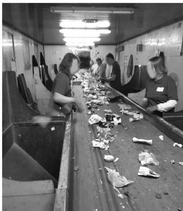
Le contenu du sac jaune et de la colonne à plastron jaune (emballages) passe sur un tapis de tri : **les différents matériaux sont séparés** (acier, aluminium, cartons, briques alimentaires et plastiques) pour être envoyés dans des usines de recyclage.
